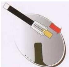
3- Poussez la bague pour retirer le bouchon facilement.
